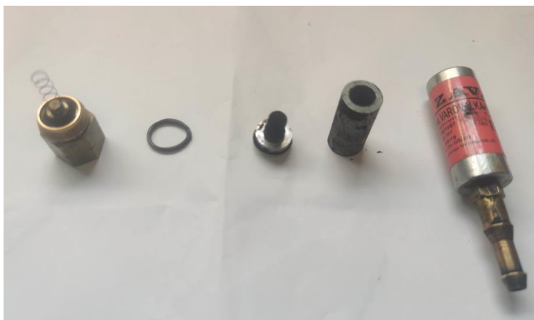
Slika 5; SV-6A, pregled SV vgrajene na odjemnem mestu po dveh letih uporabe
