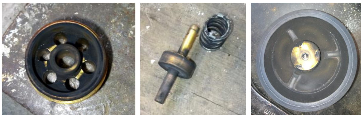
Slika 4; Zgorela notranjost reducirnega ventila
